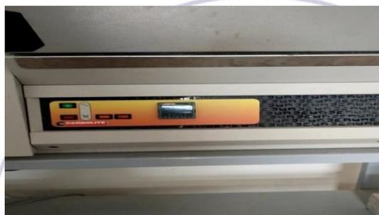
الشكل (3) الفرن الكهربائي المستخدم في المعالجات الحرارية
