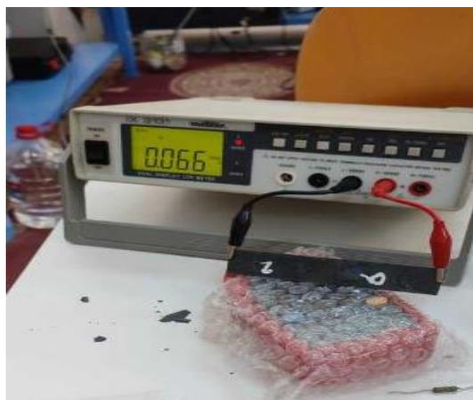
الشكل (4): جهاز قياس المقاومة الكهربائية
